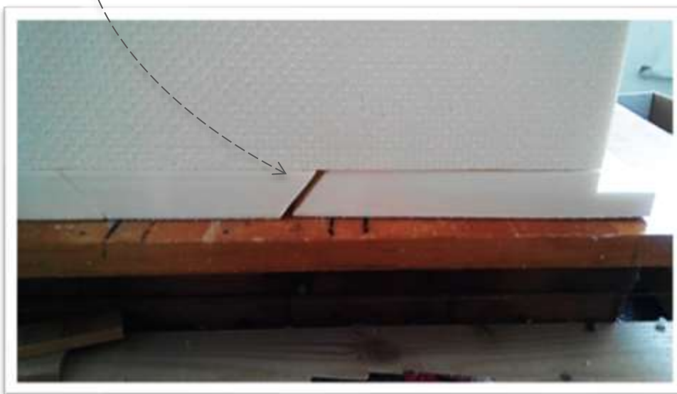
Obr. Chyba: Při tavení se nepočítalo s tavicím drátem
